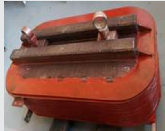
Resim 13: Kutubun Bakım-Onarımı Bitmiş Hali
